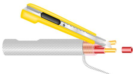
7. Desforraremos los extremos de ambos conductores.
