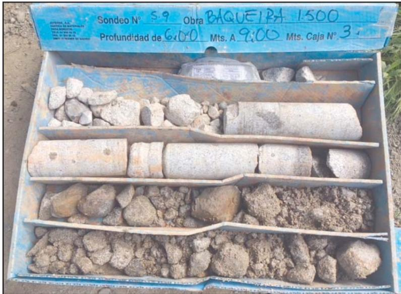
**Fotografía 4.** Detalle de la caja porta-testigos del sondeo S-9, de -6.0 a -9.0 metros.
