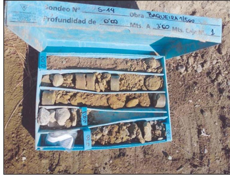
**Fotografía 2.** Detalle de la caja porta-testigos del sondeo S-14, de 0.0 a -3.0 metros.
