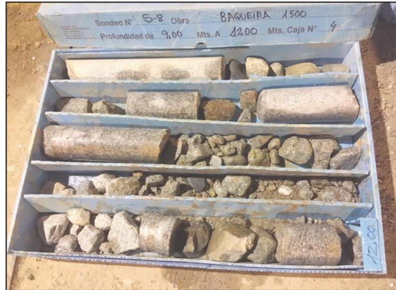
**Fotografía 4.** Detalle de la caja porta-testigos del sondeo S-8, de -9.0 a -12.00 metros.
