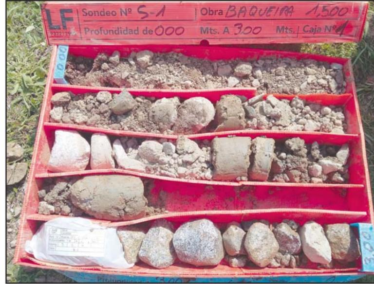
**Fotografía 2.** Detalle de la caja porta-testigos del sondeo S-1, de 0.0 a -3.0 metros.
