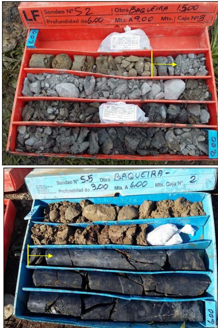
**Fotografía 20 y Fotografía 21.** Materiales de la unidad 2 en dos de los sondeos realizados, en la foto superior se pueden observar los tramos más blandos de pizarras, y a bajo, los materiales de origen más calcáreo metamórfico.
