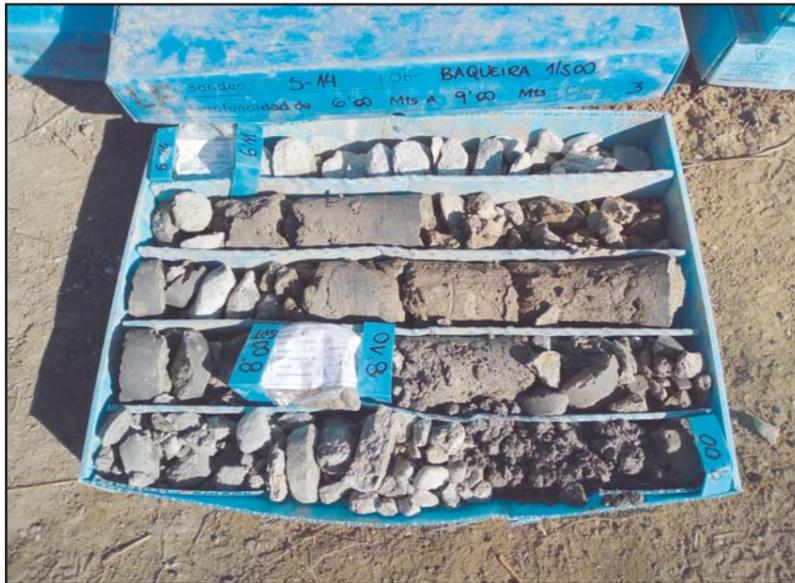
**Fotografía 4.** Detalle de la caja porta-testigos del sondeo S-14, de -6.0 a -9.0 metros.
