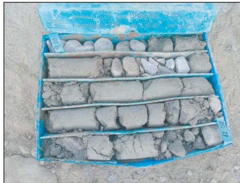
**Fotografía 5.** Detalle de la caja porta-testigos del sondeo S-12, de -9.0 a -12.00 metros.
