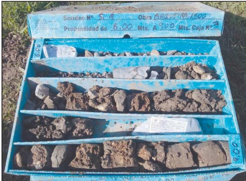
**Fotografía 4.** Detalle de la caja porta-testigos del sondeo S-1, de -6.0 a -9.0 metros.
