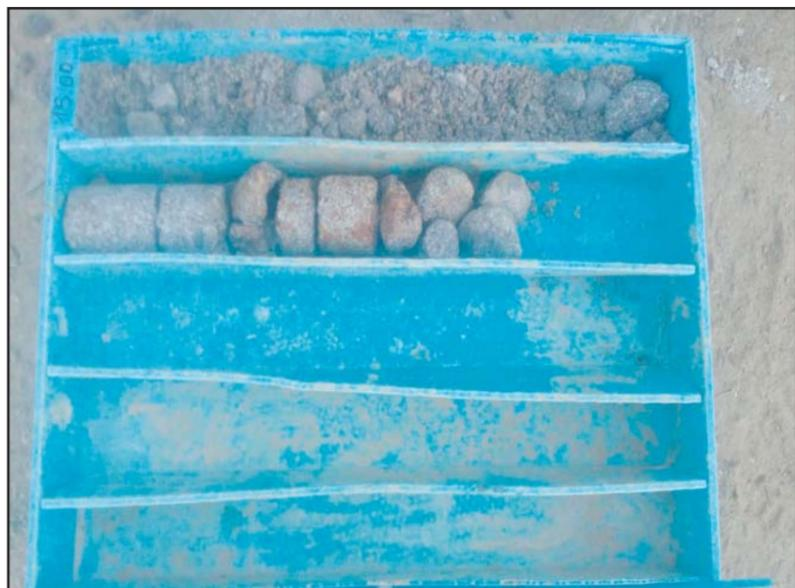
**Fotografía 7.** Detalle de la caja porta-testigos del sondeo S-15, de -15.00 a -16.00 metros.
