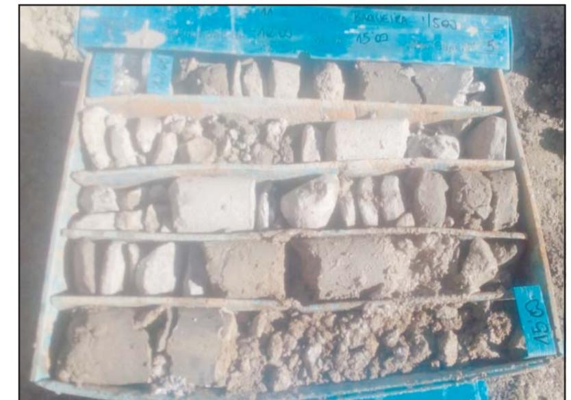
**Fotografía 6.** Detalle de la caja porta-testigos del sondeo S-11, de -12.0 a -15.00 metros.
