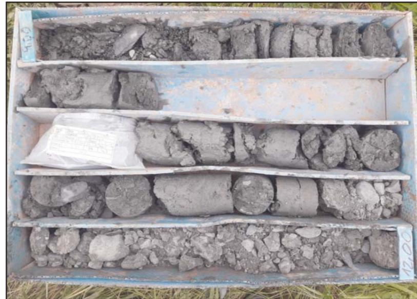
**Fotografía 5.** Detalle de la caja porta-testigos del sondeo S-7, de -9.0 a -12.00 metros.
