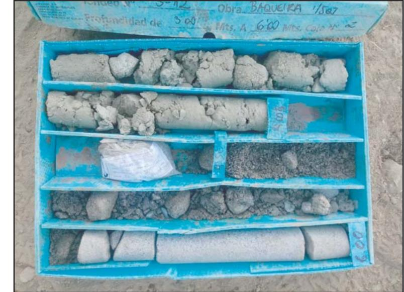
**Fotografía 3.** Detalle de la caja porta-testigos del sondeo S-12, de -3.0 a -6.0 metros.
