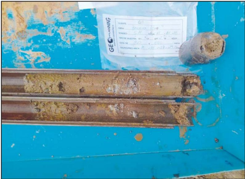
**Fotografía 10.** Detalle del ensayo SPT-2 del sondeo S-11 entre las cotas de -8.0 a -8.60 metros.
