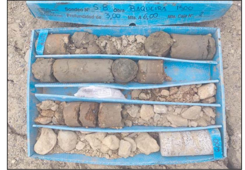
**Fotografía 3.** Detalle de la caja porta-testigos del sondeo S-8, de -3.0 a -6.0 metros.
