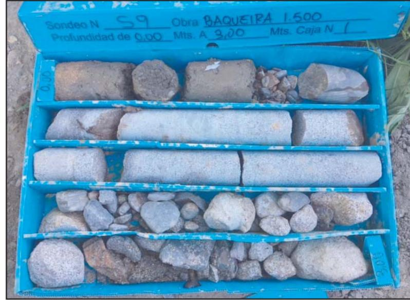
**Fotografía 2.** Detalle de la caja porta-testigos del sondeo S-9, de 0.0 a -3.0 metros.
