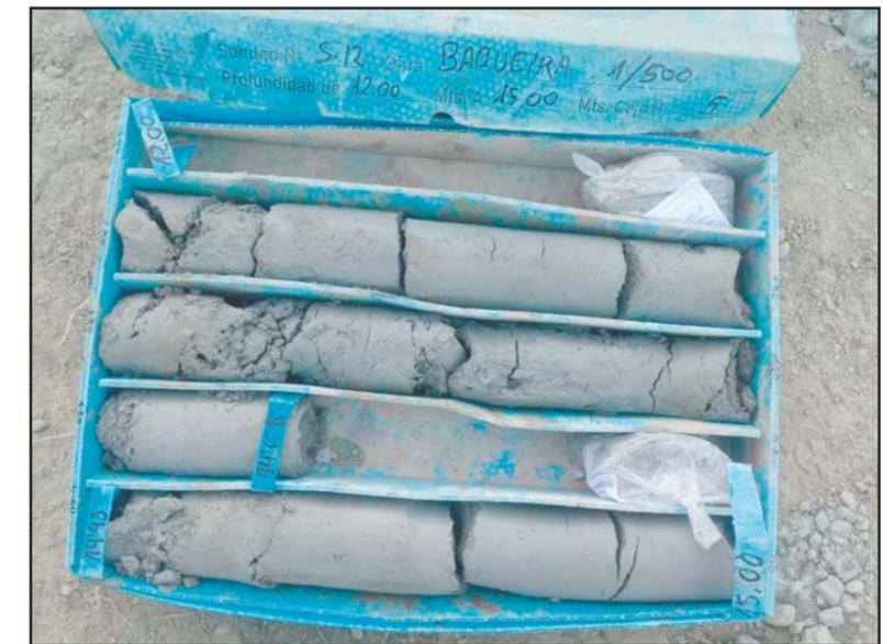
**Fotografía 6.** Detalle de la caja porta-testigos del sondeo S-12, de -12.0 a -15.00 metros.
