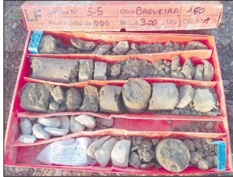
**Fotografía 2.** Detalle de la caja porta-testigos del sondeo S-5, de 0.0 a -3.0 metros.
