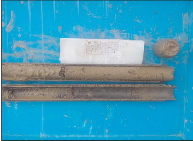
**Fotografía 7.** Detalle del ensayo SPT-2 del sondeo S-10, de -5.00 a -5.60 metros.
