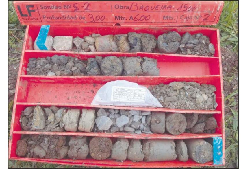
**Fotografía 3.** Detalle de la caja porta-testigos del sondeo S-2, de -3.0 a -6.0 metros.
