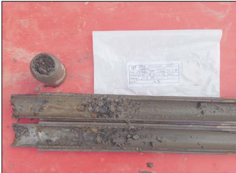
**Fotografía 4.** Detalle de los materiales recuperado en el ensayo SPT.
