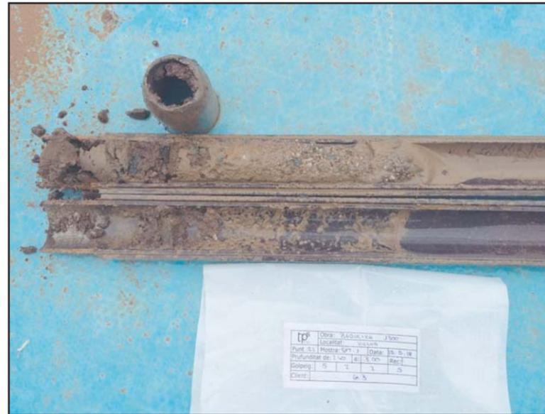
**Fotografías de 5 a la 7.** Detalle de los materiales recuperados en los diferentes ensayos SPT.
