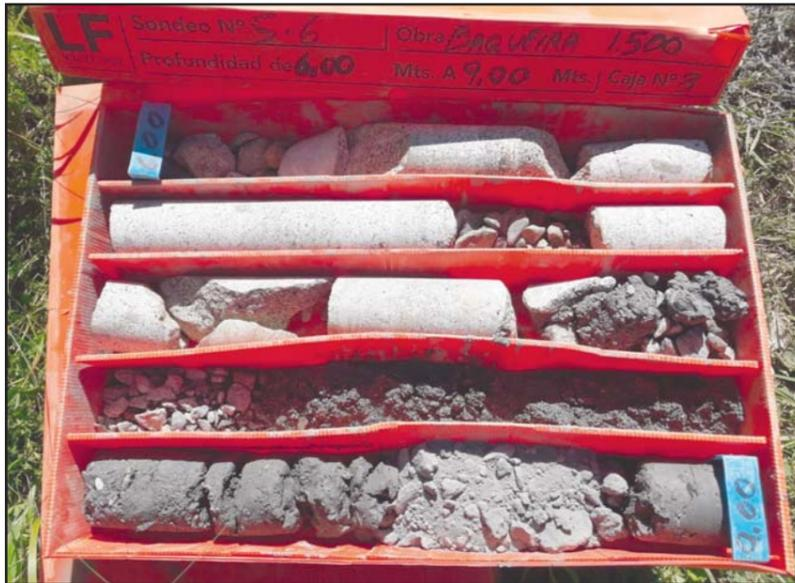
**Fotografía 4.** Detalle de la caja porta-testigos del sondeo S-6, de -6.0 a -9.0 metros.
