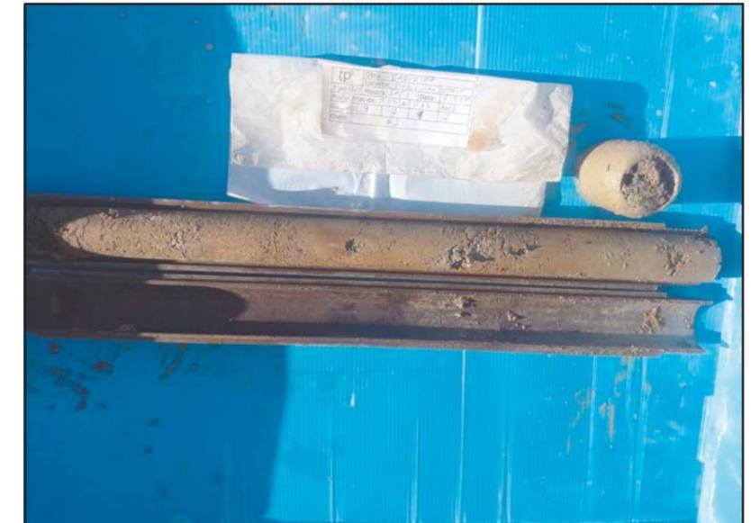
**Fotografía 6.** Detalle del ensayo SPT-1 del sondeo S-10, de -3.00 a -3.60 metros.
