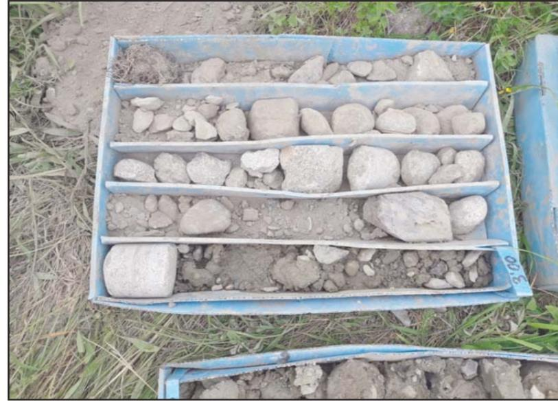
**Fotografía 2.** Detalle de la caja porta-testigos del sondeo S-7, de 0.0 a -3.0 metros.
