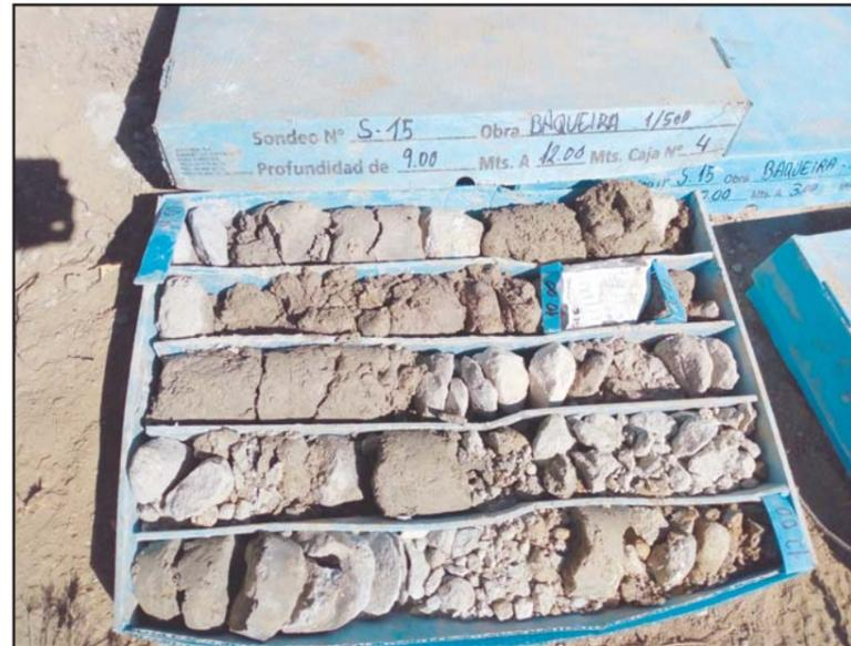
**Fotografía 5.** Detalle de la caja porta-testigos del sondeo S-15, de -9.0 a -12.00 metros.
