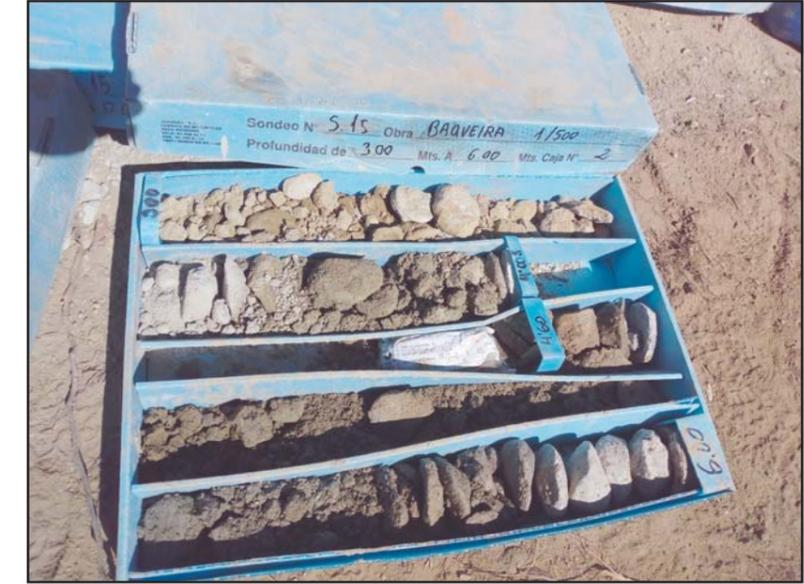
**Fotografía 3.** Detalle de la caja porta-testigos del sondeo S-15, de -3.0 a -6.0 metros.
