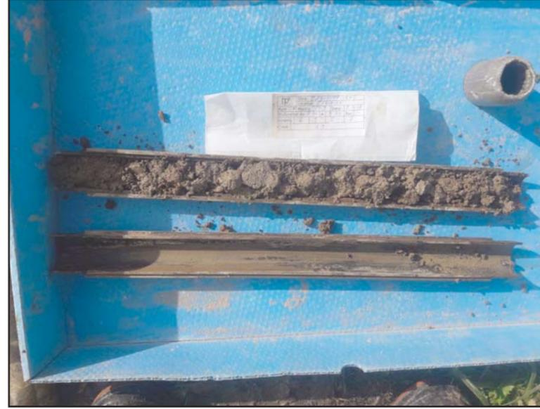
**Fotografía 8.** Detalle del ensayo SPT-3 del sondeo S-10, de -10.00 a -10.03 metros.
