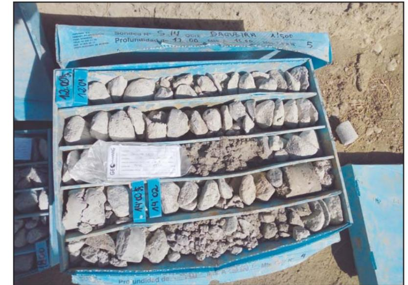
**Fotografía 6.** Detalle de la caja porta-testigos del sondeo S-14, de -12.0 a -15.00 metros.
