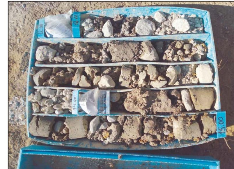
**Fotografía 6.** Detalle de la caja porta-testigos del sondeo S-15, de -12.0 a -15.00 metros.
