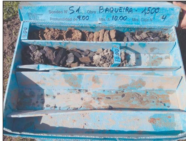
**Fotografía 5.** Detalle de la caja porta-testigos del sondeo S-1, de -9.0 a -10.0 metros.
