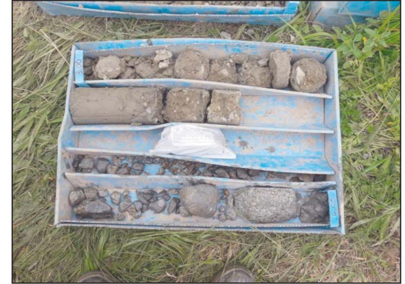
**Fotografía 3.** Detalle de la caja porta-testigos del sondeo S-7, de -3.0 a -6.0 metros.
