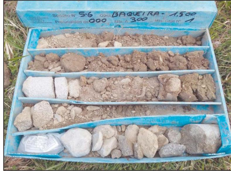
**Fotografía 2.** Detalle de la caja porta-testigos del sondeo S-6, de 0.0 a -3.0 metros.
