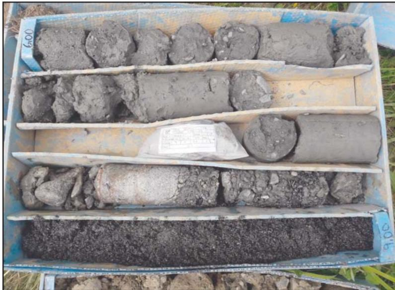
**Fotografía 4.** Detalle de la caja porta-testigos del sondeo S-7, de -6.0 a -9.0 metros.
