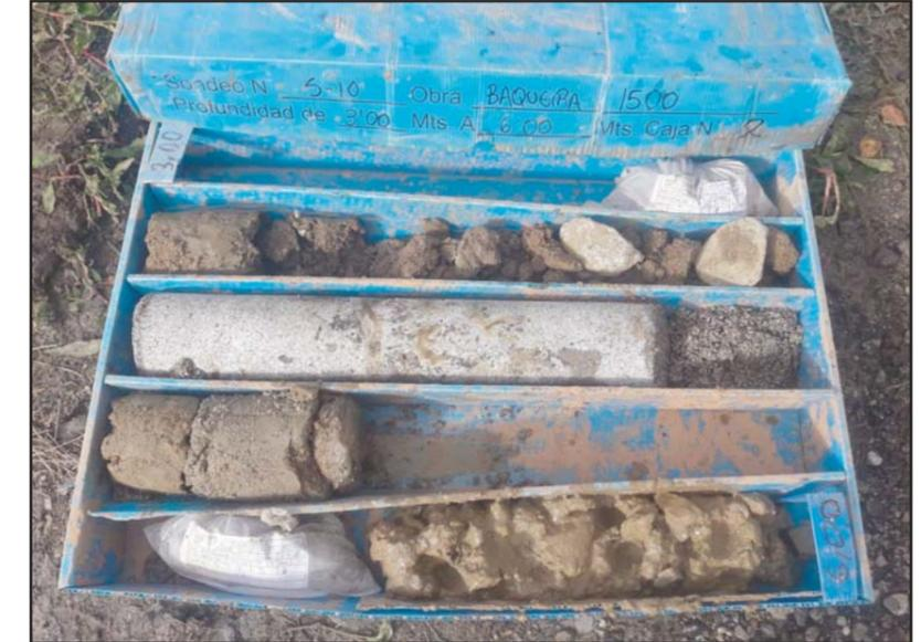
**Fotografía 3.** Detalle de la caja porta-testigos del sondeo S-10, de -3.0 a -6.0 metros.
