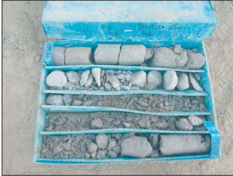
**Fotografía 7.** Detalle de la caja porta-testigos del sondeo S-12 , de -15.00 a -18 .00 metros.
