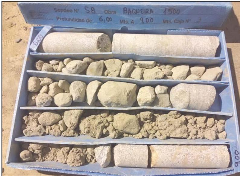
**Fotografía 4.** Detalle de la caja porta-testigos del sondeo S-8, de -6.0 a -9.0 metros.
