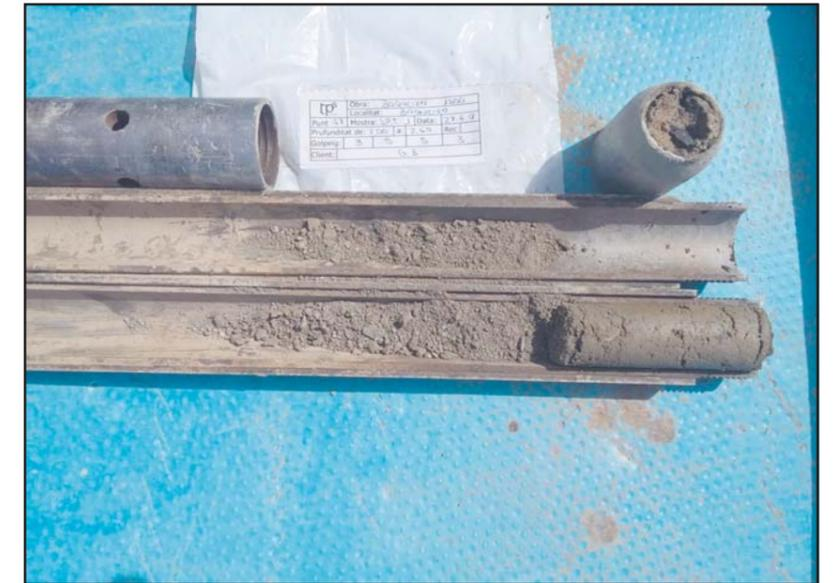
**Fotografías de la 6 a la 7.** Detalle de los materiales recuperados en los diferentes ensayos SPT.
