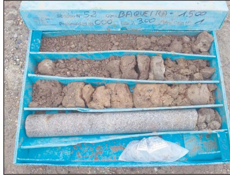
**Fotografía 2.** Detalle de la caja porta-testigos del sondeo S-2, de 0.0 a -3.0 metros.
