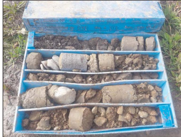
**Fotografía 2.** Detalle de la caja porta-testigos del sondeo S-10, de 0.0 a -3.0 metros.
