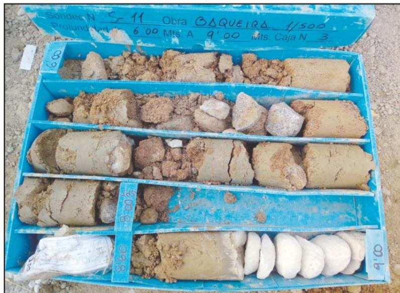
**Fotografía 4.** Detalle de la caja porta-testigos del sondeo S-11, de -6.0 a -9.0 metros.
