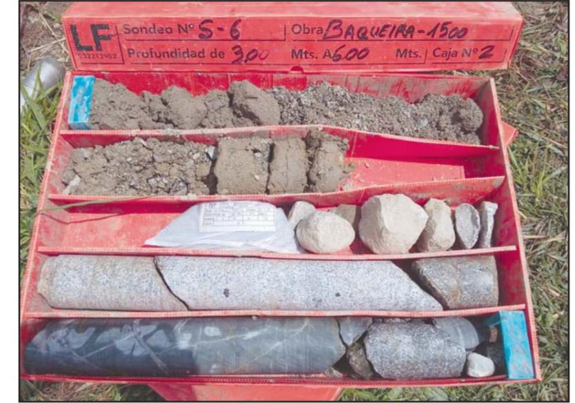
**Fotografía 3.** Detalle de la caja porta-testigos del sondeo S-6, de -3.0 a -6.0 metros.
