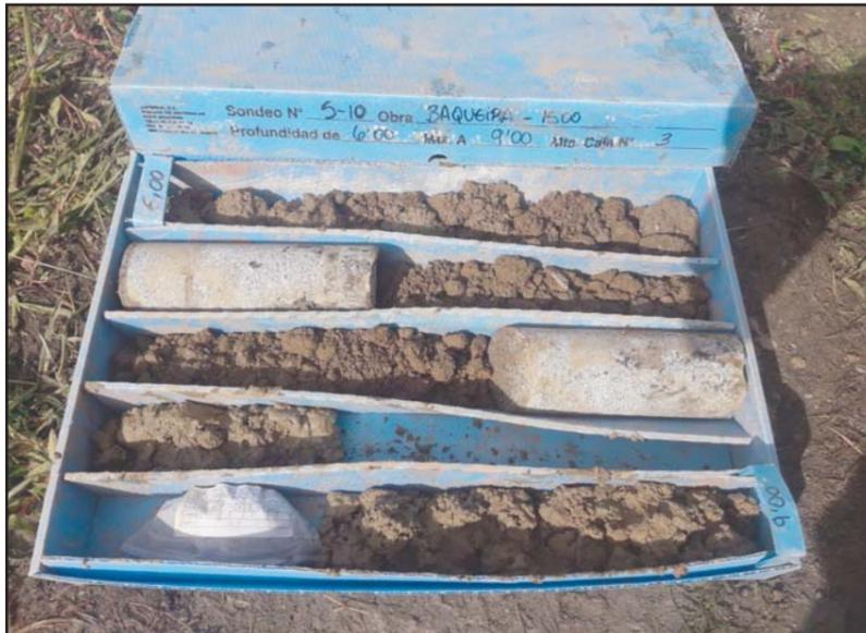
**Fotografía 4.** Detalle de la caja porta-testigos del sondeo S-10, de -6.0 a -9.0 metros.
