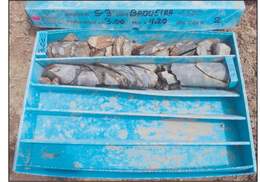
**Fotografía 3.** Detalle de la caja porta-testigos del sondeo S-3, de -3.0 a -4.2 metros.
