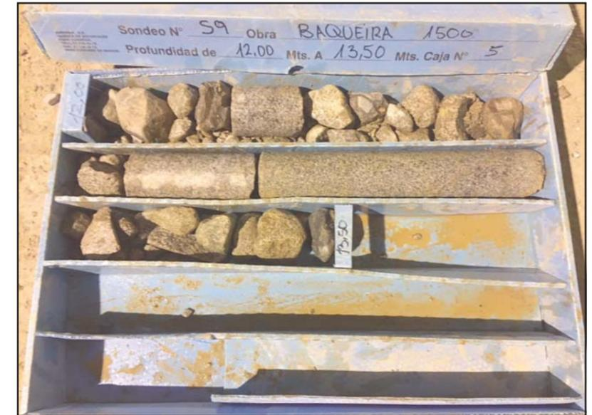
**Fotografía 6.** Detalle de la caja porta-testigos del sondeo S-9, de -12.0 a -13.50 metros.
