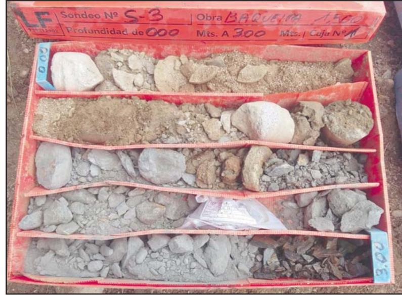
**Fotografía 2.** Detalle de la caja porta-testigos del sondeo S-3, de 0.0 a -3.0 metros.
