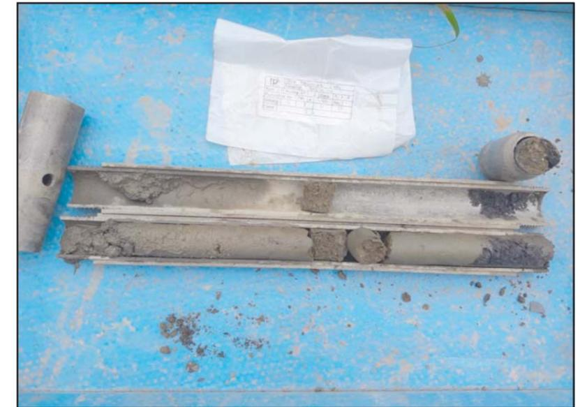
**Fotografías de la 6 a la 10.** Detalle de los materiales recuperados en los diferentes ensayos SPT.
