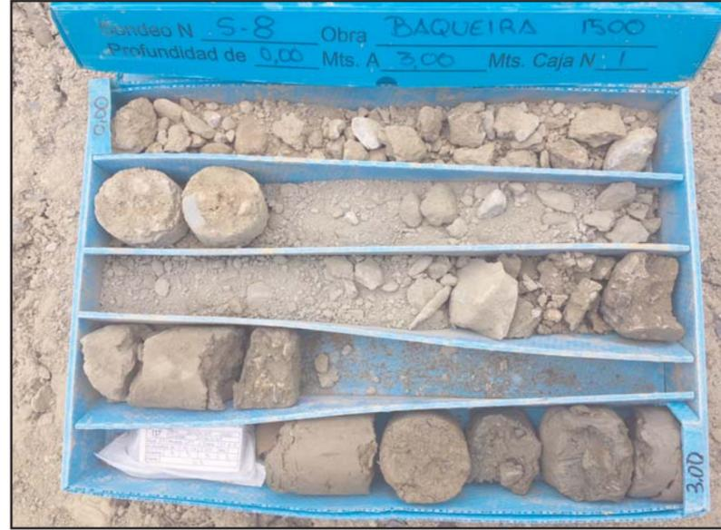
**Fotografía 2.** Detalle de la caja porta-testigos del sondeo S-8, de 0.0 a -3.0 metros.
