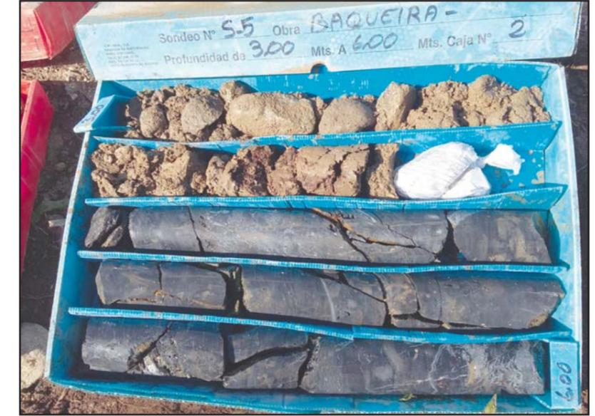
**Fotografía 3.** Detalle de la caja porta-testigos del sondeo S-5, de -3.0 a -6.0 metros.
