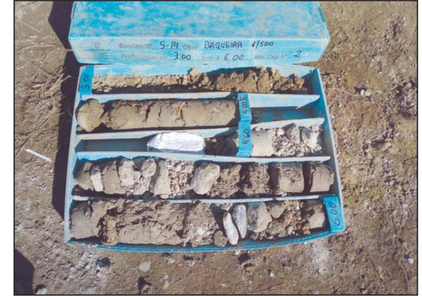
**Fotografía 3.** Detalle de la caja porta-testigos del sondeo S-14, de -3.0 a -6.0 metros.
