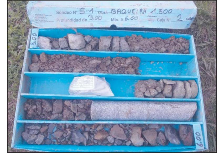
**Fotografía 3.** Detalle de la caja porta-testigos del sondeo S-1, de -3.0 a -6.0 metros.
