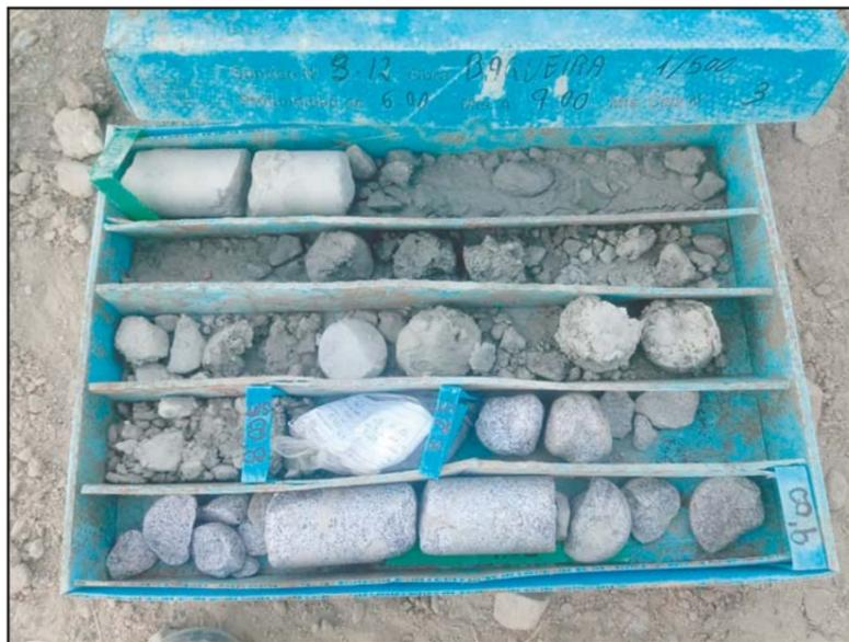
**Fotografía 4.** Detalle de la caja porta-testigos del sondeo S-12, de -6.0 a -9.0 metros.
