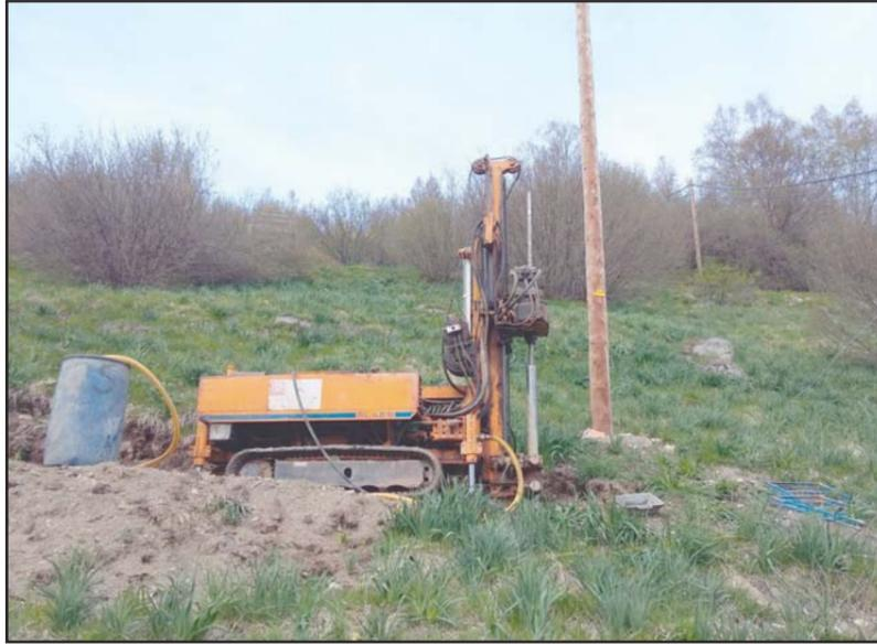
**Fotografía 1.** Máquina emplazada en el sondeo S-5.
