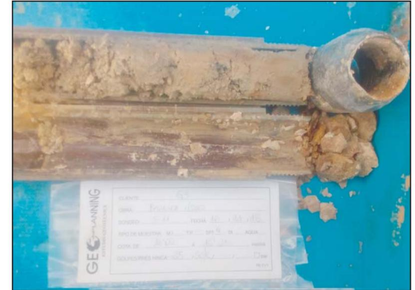
**Fotografía 12.** Detalle del ensayo SPT-4 del sondeo S-11 entre las cotas de -16.0 a -16.25 metros.
