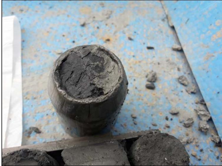
**Fotografía 18 y Fotografía 19.** Materiales de la unidad 2 en uno de los sondeos realizados, en la foto superior se pueden observar los tramos iniciales de estos materiales y debajo detalle de uno de los ensayos SPT realizados en los materiales de este nivel.
