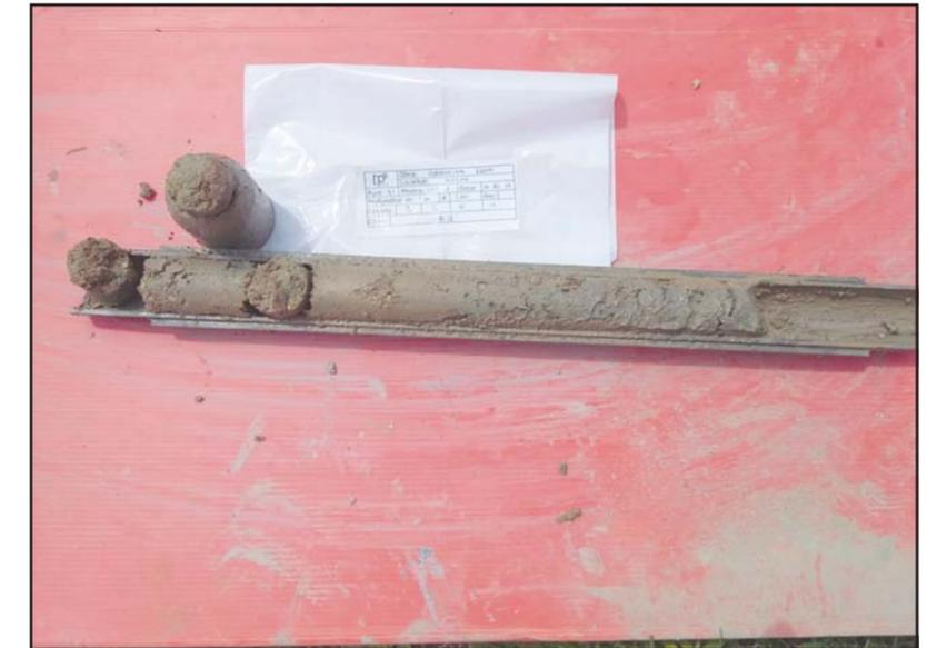
**Fotografías de la 6 a la 9.** Detalle de los materiales recuperados en los diferentes ensayos SPT's.
