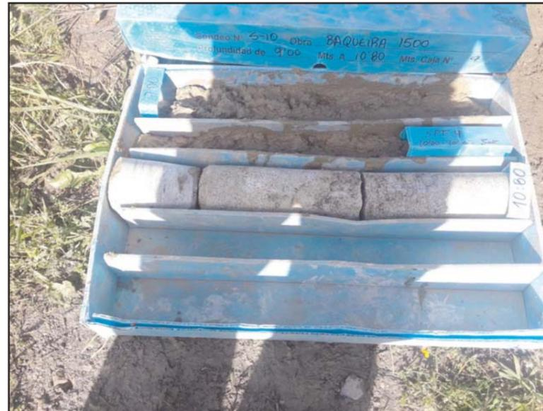
**Fotografía 5.** Detalle de la caja porta-testigos del sondeo S-10, de -9.0 a -10.80 metros.
