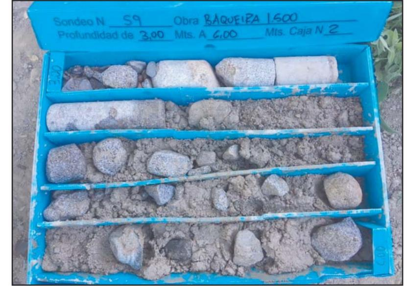
**Fotografía 3.** Detalle de la caja porta-testigos del sondeo S-9, de -3.0 a -6.0 metros.
