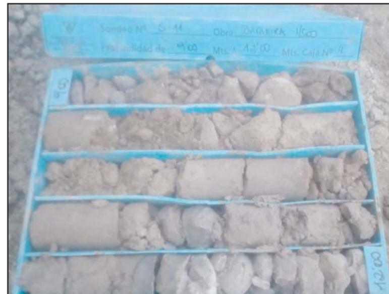
**Fotografía 5.** Detalle de la caja porta-testigos del sondeo S-11, de -9.0 a -12.0 metros.
