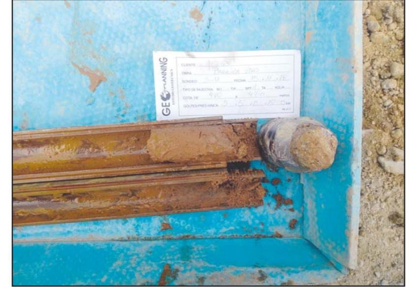
**Fotografía 9.** Detalle del ensayo SPT-1 del sondeo S-11 entre las cotas de -4.0 a -4.60 metros.
