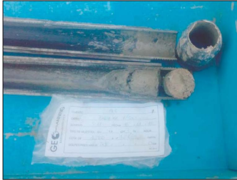
**Fotografía 11.** Detalle del ensayo SPT-3 del sondeo S-11 entre las cotas de -12.0 a -12.08 metros.
