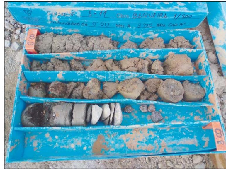
**Fotografía 2.** Detalle de la caja porta-testigos del sondeo S-11, de 0.0 a -3.0 metros.
