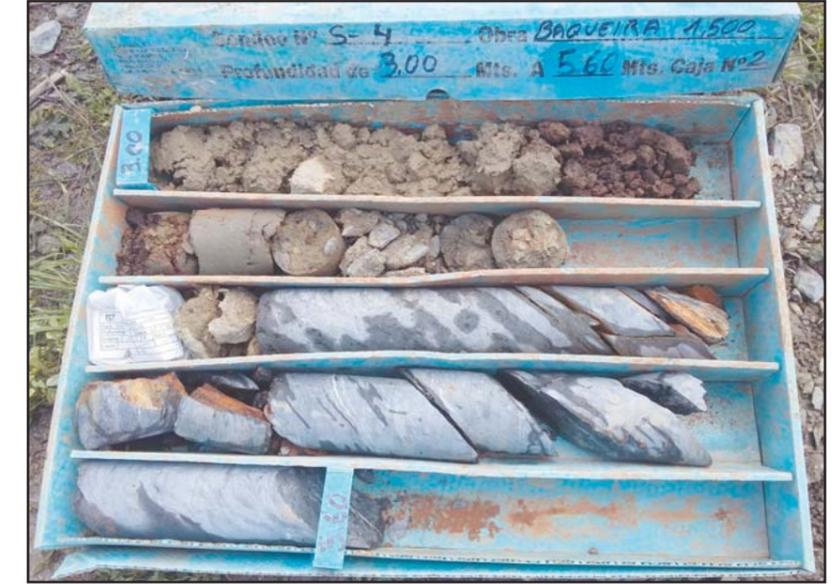
**Fotografía 3.** Detalle de la caja porta-testigos del sondeo S-4, de -3.0 a -5.60 metros.
