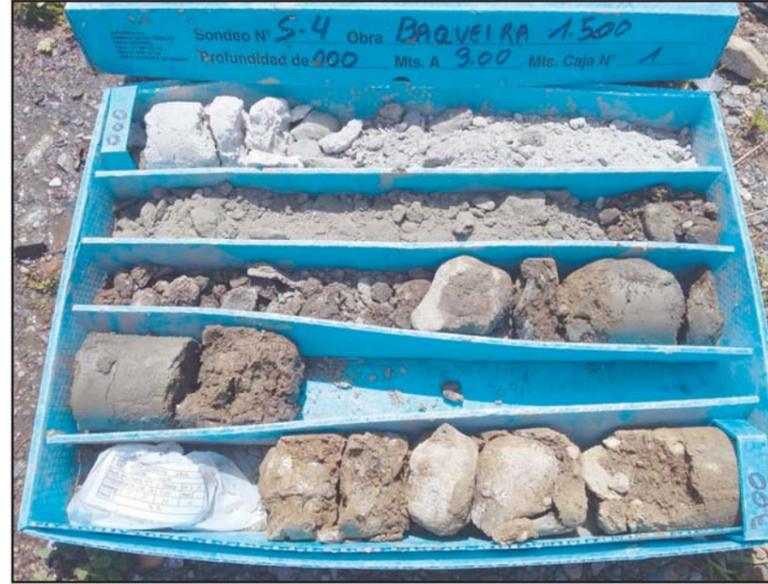
**Fotografía 2.** Detalle de la caja porta-testigos del sondeo S-4, de 0.0 a -3.0 metros.
