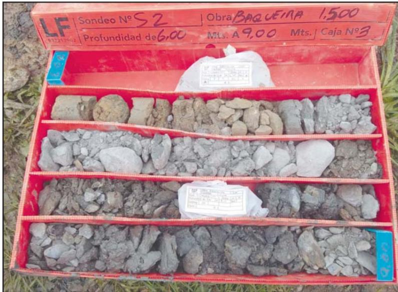
**Fotografía 4.** Detalle de la caja porta-testigos del sondeo S-2, de -6.0 a -9.0 metros.
