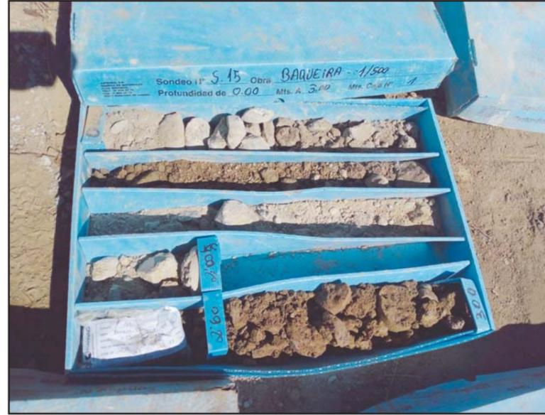
**Fotografía 2.** Detalle de la caja porta-testigos del sondeo S-15, de 0.0 a -3.0 metros.
