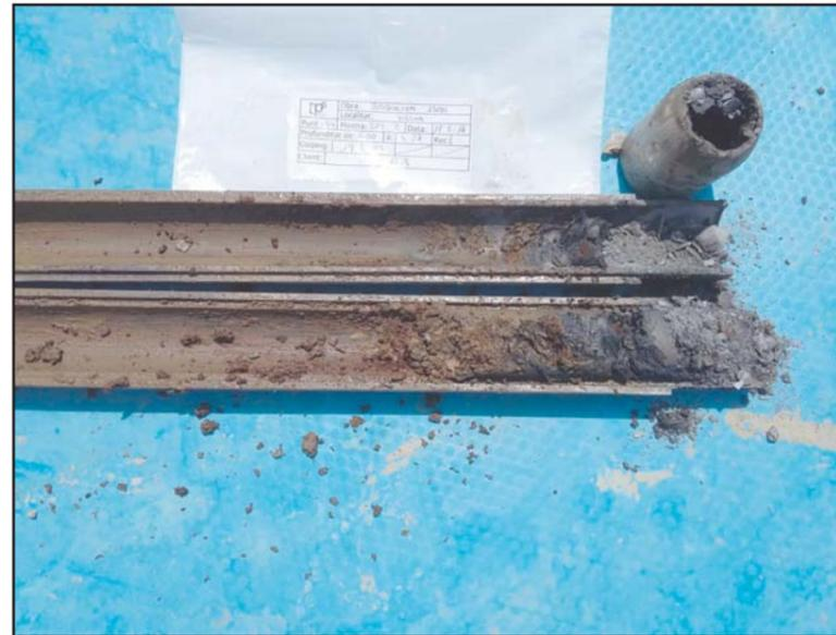
**Fotografías 4 y 5.** Detalle de los materiales recuperados en los diferentes ensayos SPT.
