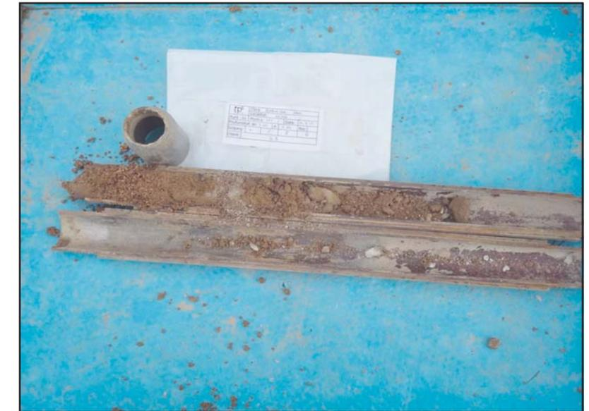
**Fotografías 4 y 5.** Detalle de los materiales recuperados en los diferentes ensayos SPT.
