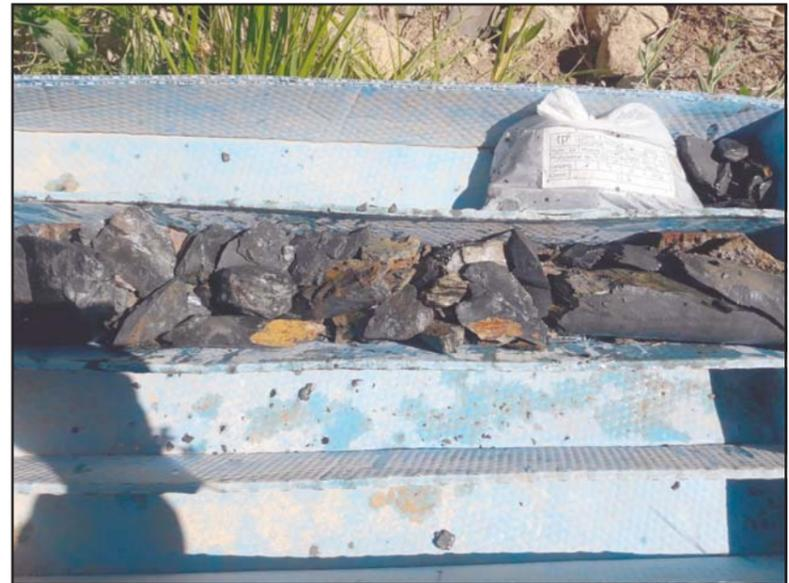
**Fotografía 5.** Detalle de la caja porta-testigos del sondeo S-6, de -9.0 a -10.50 metros.
