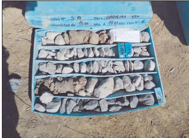
**Fotografía 7.** Detalle de la caja porta-testigos del sondeo S-14, de -15.00 a -18.00 metros.
