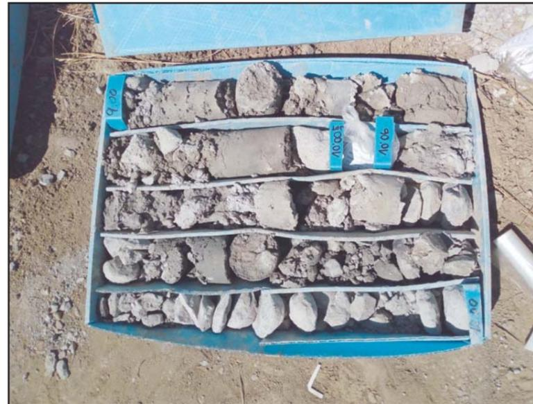
**Fotografía 5.** Detalle de la caja porta-testigos del sondeo S-14, de -9.0 a -12.00 metros.
