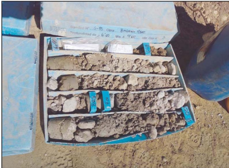
**Fotografía 4.** Detalle de la caja porta-testigos del sondeo S-15, de -6.0 a -9.0 metros.
