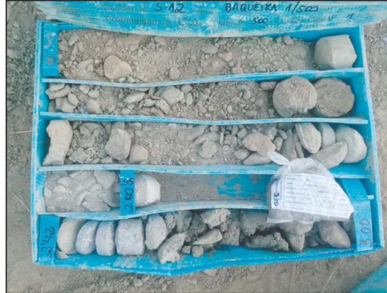
**Fotografía 2.** Detalle de la caja porta-testigos del sondeo S-12, de 0.0 a -3.0 metros.
