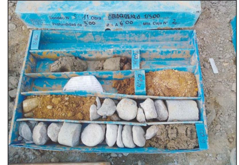
**Fotografía 3.** Detalle de la caja porta-testigos del sondeo S-11, de -3.0 a -6.00 metros.
