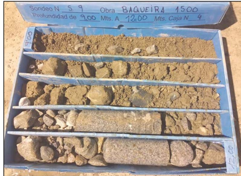
**Fotografía 5.** Detalle de la caja porta-testigos del sondeo S-9, de -9.0 a -12.00 metros.
