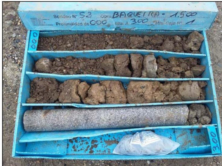
**Fotografía 8.** Ejemplo de una de las cajas dónde se depositan los materiales perforados.
