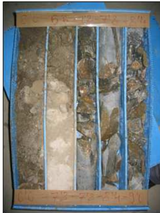
Caja nº 3: Testigos extraídos del sondeo S-1 comprendidos entre 6,00 y 9,00 m de profundidad.
