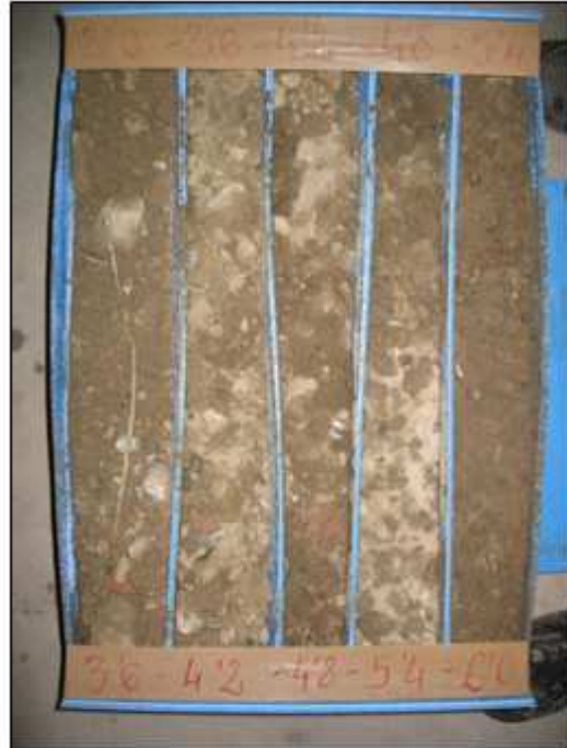
Caja nº 2: Testigos extraídos del sondeo S-1 comprendidos entre 3,00 a 6,00 m de profundidad.
