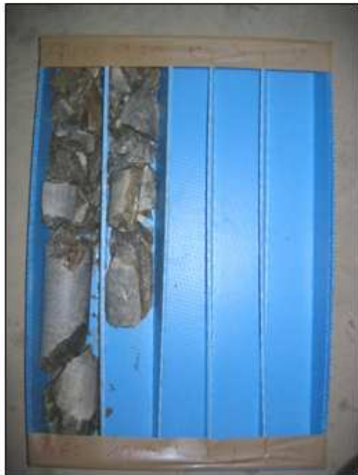
Caja nº 4: Testigos extraído del sondeo S-1 comprendidos entre 9,00 y 10,00 m de profundidad.
