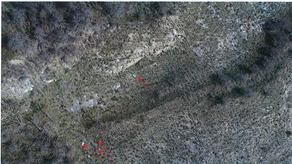
Imatge 6: vista aèria del reconeixement de camp amb dron, on s'observen alguns blocs aturats al peu de l'espadat, fletxes vermelles.
