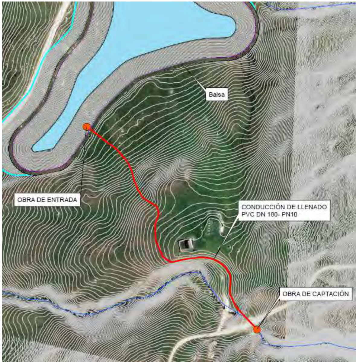
Trazado de la tubería
