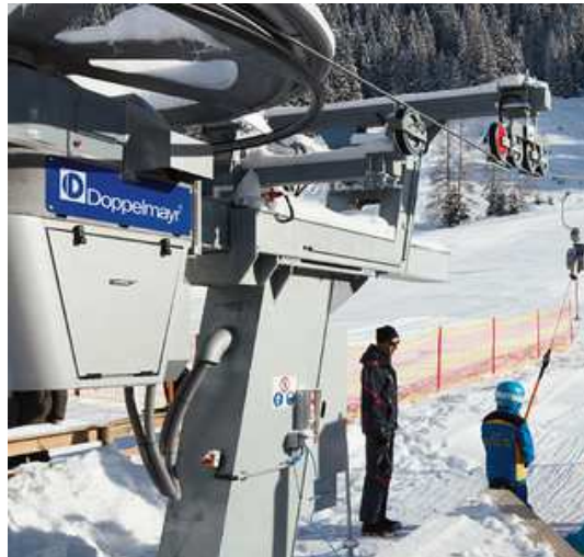
Imatge 4.6. Tipus d'estacions inferiors que s'instal·larà al TQ de debutants Pla de Beret.
