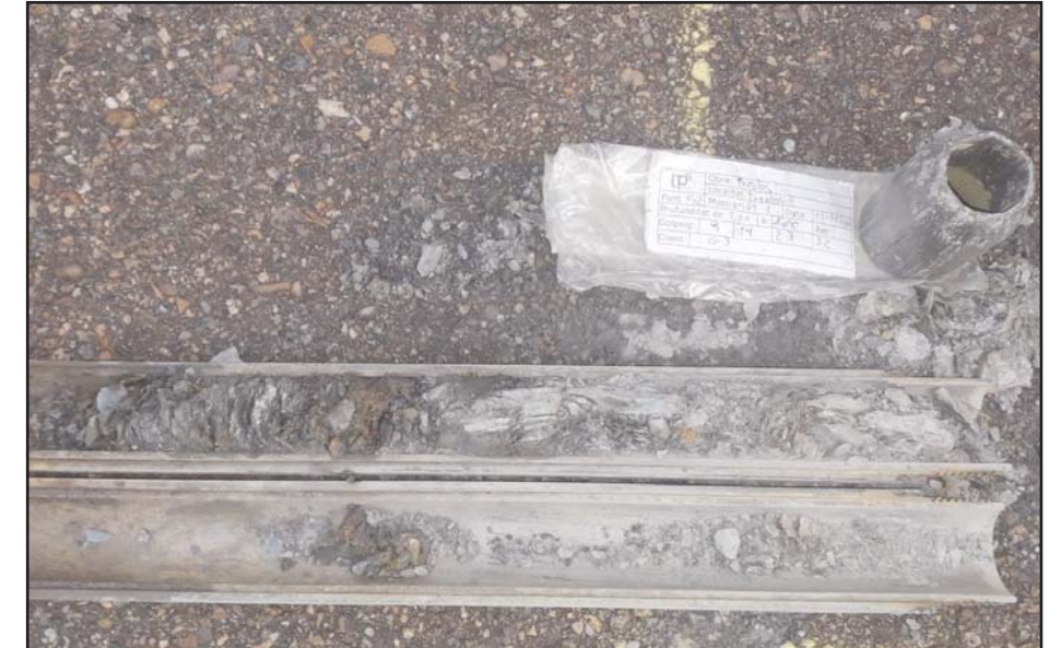
Fotografia 3. Detall dels materials recuperats en els diferents de l'assaig SPT-1, de 1.0 a 1.6 metres.
