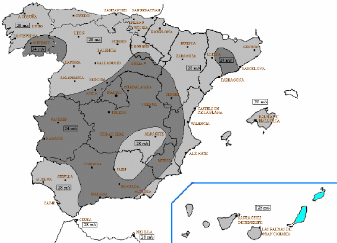
Figura 3.- Mapa de isotacas para la obtención de la velocidad de referencia del viento
