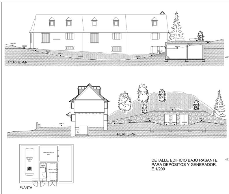
DETALLE EDIFICIO BAJO RASANTE PARA DEPÓSITOS Y GENERADOR. E. 1/200
