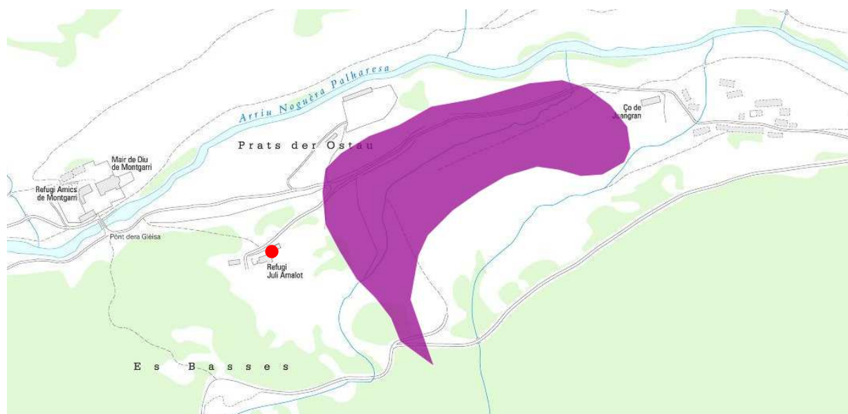
Figura 7. Con de dejecció present a les immediacions de la zona d'actuació.
