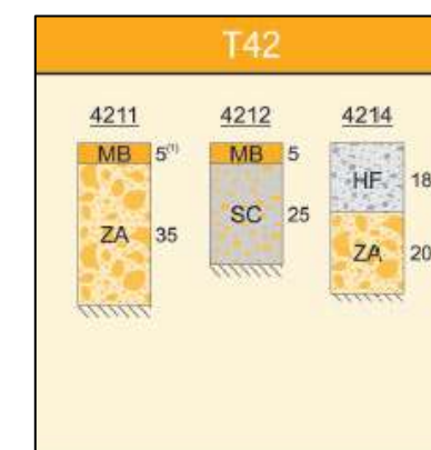
Figura 3 Opcions de paquet de ferm per a categoria de trànsit T42 sobre esplanada tipus E1 (Font: Norma 6.1-IC).
