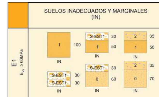
Figura 2 Opcions per a la formació d'esplanada tipus E1 sobre sòls inadequats (Font: Norma 6.1-IC).
