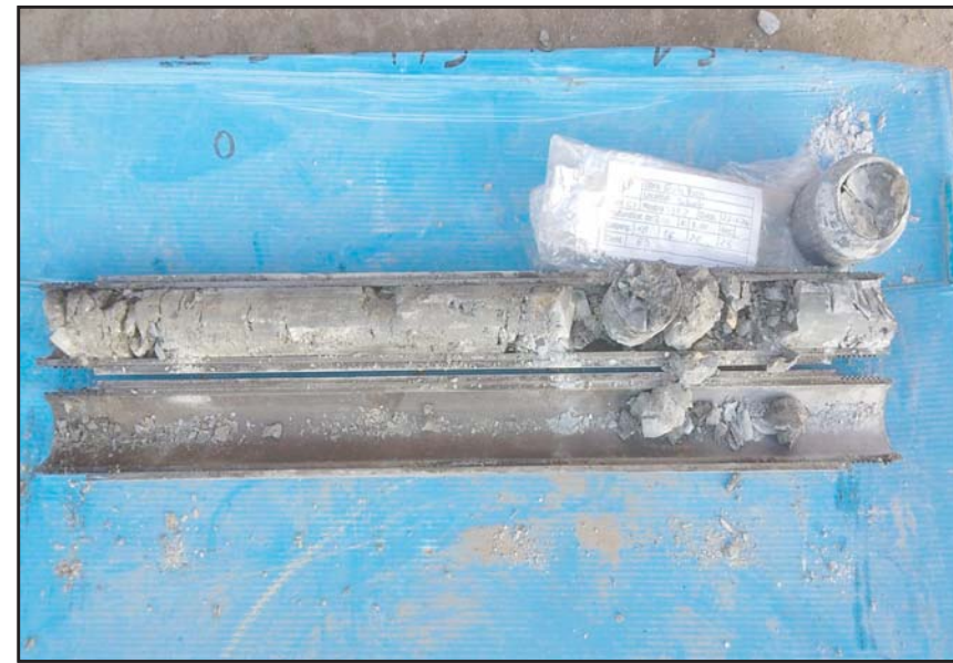
Fotografia 5. Material recuperat en l'assaig SPT-2.
