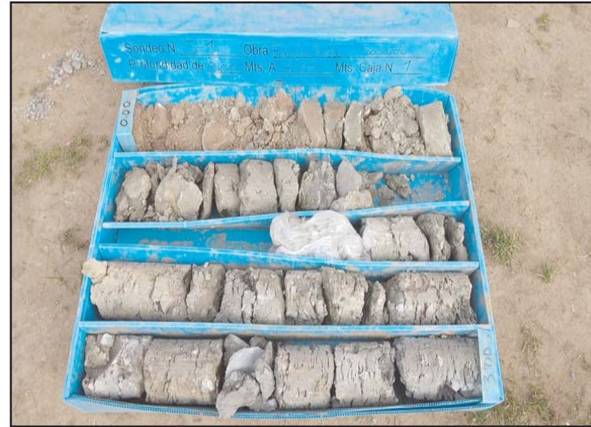
Fotografia 2. Material recuperat en el sondeig S-1 entre les cotes de 0.00 a -3.00 metres de profunditat.
