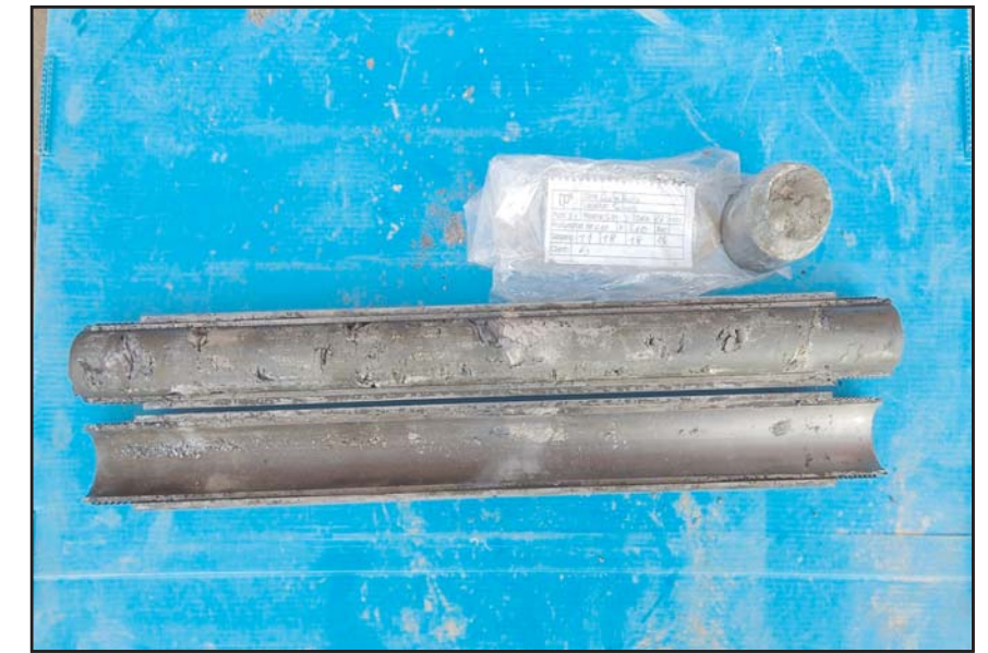
Fotografia 6. Material recuperat en l'assaig SPT-3.
