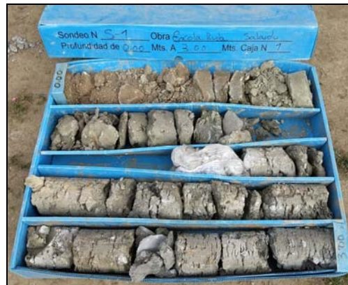
Fotografia 4. Detall dels materials del 1er nivell recuperats durant la realització del sondeig S-1.
