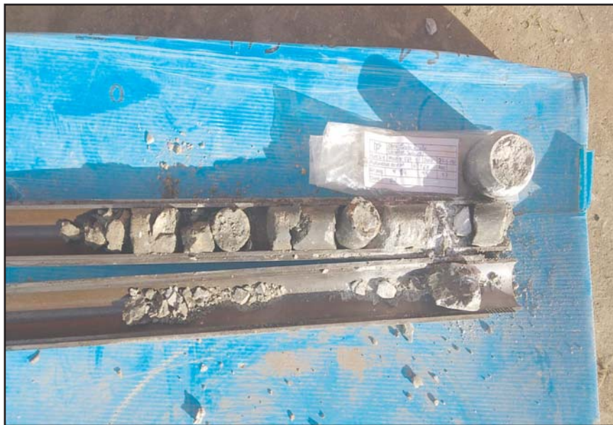
Fotografia 4. Material recuperat en l'assaig SPT-1.
