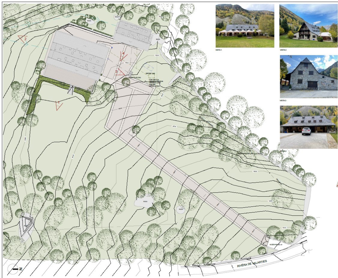
Figura 4. Situació actual de detall amb dues edificacions existents, una plataforma de formigó d'accés i una plataforma de fusta.
