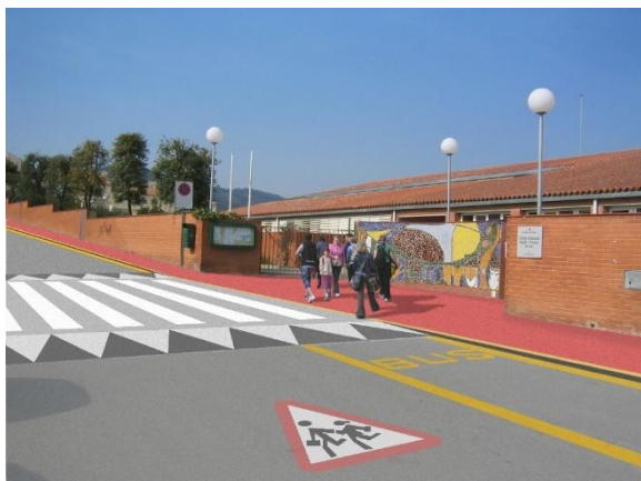
Figura 44. Fotomuntatge proposta de plataforma sobreelevada que cobreixi tot l'entorn d'accés a l'escola i que inclogui parada de transport col·lectiu i diferents elements de mobiliari urbà
