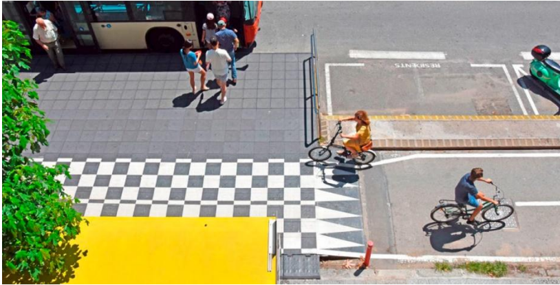
Imatge 57. Exemple de carril integrat a Barcelona. Plataforma per accedir l'autobús i integració del carril pedalable. Solució de Zicla, Sistema Vectorial
