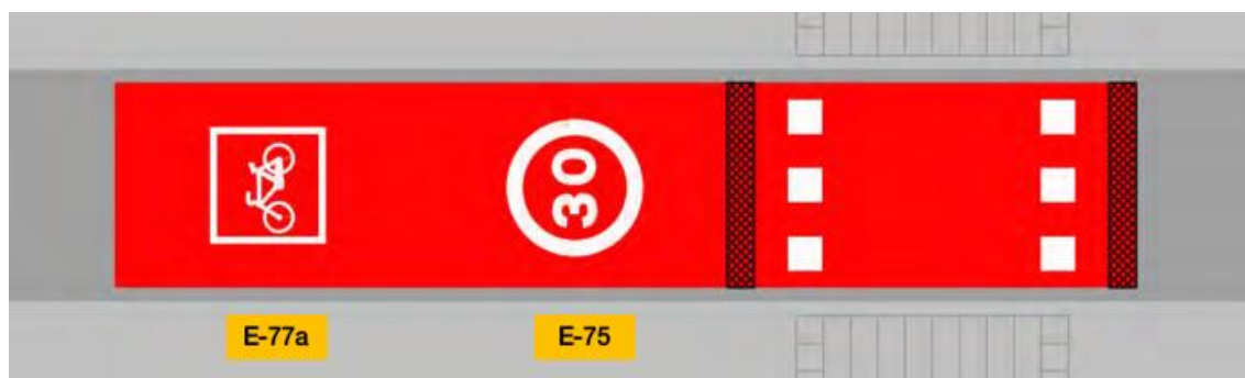
Figura 32. Exemple d'accés a carrer de zona 30: Pas de vianants elevat per reduir la velocitat dels vehicles i senyalització horitzontal
